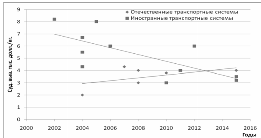
Рис. 3. Динамика ресурсоотдачи (удельной стоимости выведения) от выведения ПН на НОО для РН среднего и тяжелого классов в 2000-2016 гг. Источник: составлено автором по данным производителей космических транспортных систем.
