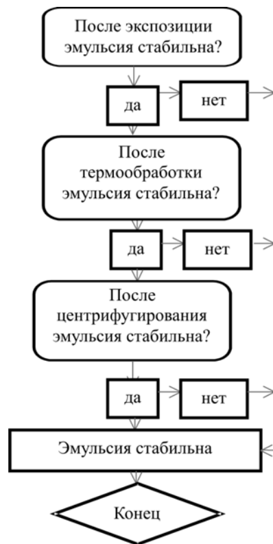
Рис. 2. Схема проверки стабильности эмульсии
